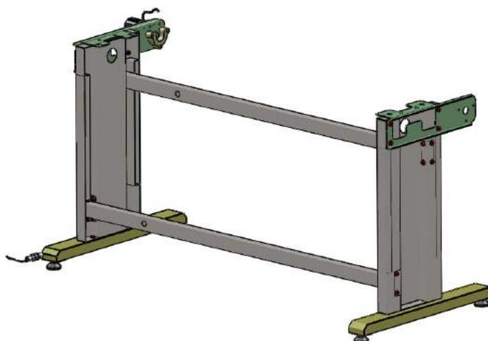
Il disegno sopra mostra il montaggio del piede d'appoggio al S160.
