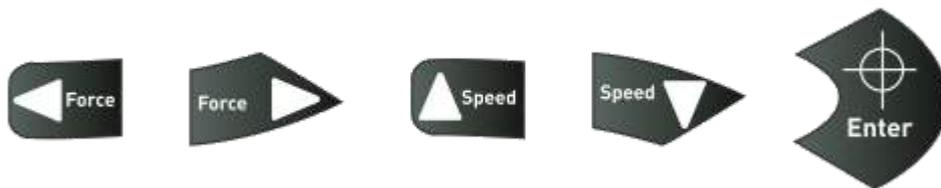
Per poter porre un punto d'inizio corretto per plottare, muovere la testina della lama e il vinile così che la lama si trovi nell'angolo anteriore destro del vinile. Confermare questo con il punto 0 e premere il reticolo, in questo modo l'apparecchio va automaticamente nella modalità online.
