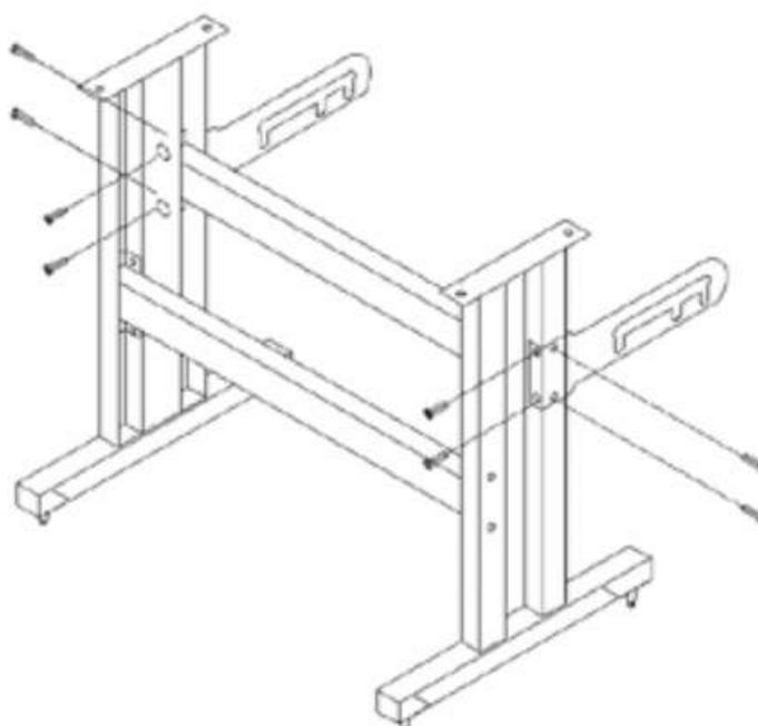
Il piede d'appoggio del plotter da taglio Secabo può essere montato semplicemente utilizzando i pezzi compresi nella fornitura, in modo analogo a quanto indicato nel disegno con particolari smontati sopra raffigurato.
