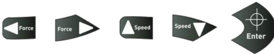
Nella modalità Offline la testina della lama può essere spostata da destra a sinistra premendo le frecce „Force“ e con il il tasto “Speed” da avanti in dietro. Nel display si possono vedere le corrispondenti coordinate X e Y.
